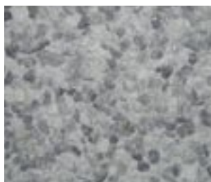
Abgetragene Oberfläche mit Hardeberga-Granit
